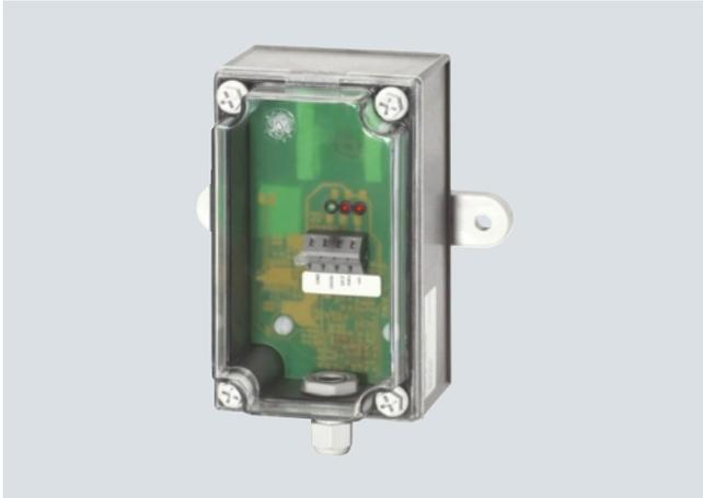
Es posible sincronizar con este módulo el reloj de tiempo real de los sistemas de automatización SIMATIC S7-200, S7-300 y S7-400 con la hora oficial del emisor de señal horaria DCF 77 del Instituto Federal Físico-Técnico de Braunschweig, Alemania.
