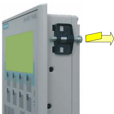
Figura 4-11 Colocar los tensores
