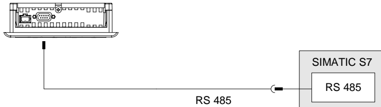
Figura 4-15 Conectar el autómata a un OP 77A
